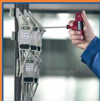
Les rondelles élastiques compressées à plat signalent au monteur le couple exact.
