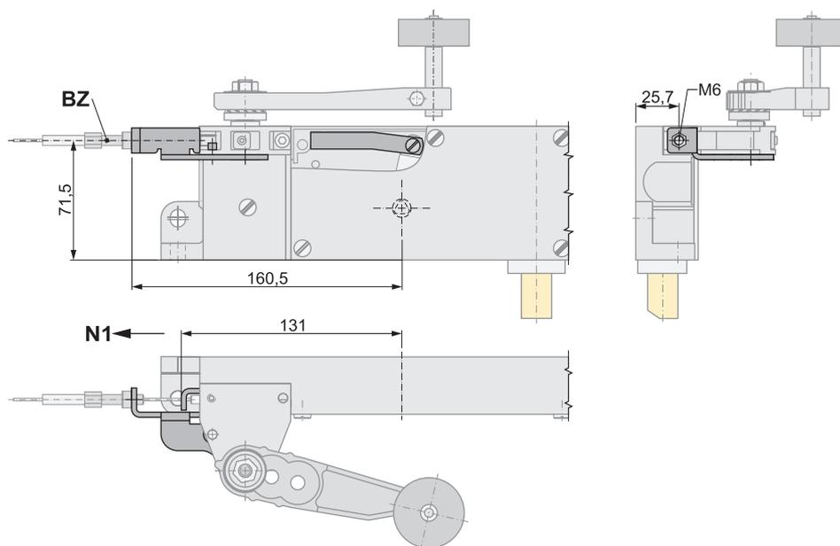
.14 in Kombination mit Betätigung .50 (über Seitenlagerbock parallel aufgesetzt)
