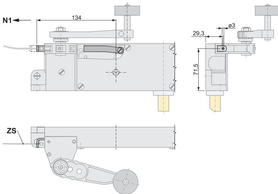
.5 in Kombination mit Betätigung .50 (über Seitenlagerbock parallel aufgesetzt)
