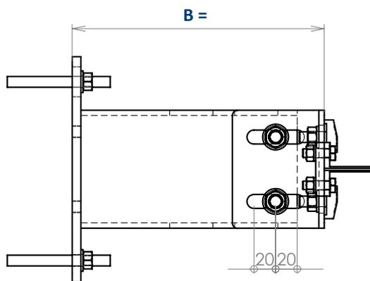
Distance entre mur et dos du guides : **B =** mm
