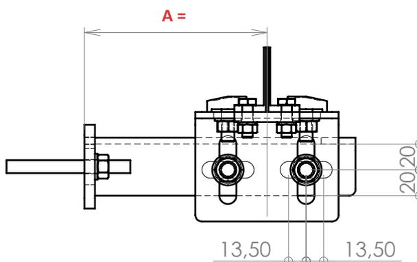
Distance entre mur et axe des guides : **A =** mm
