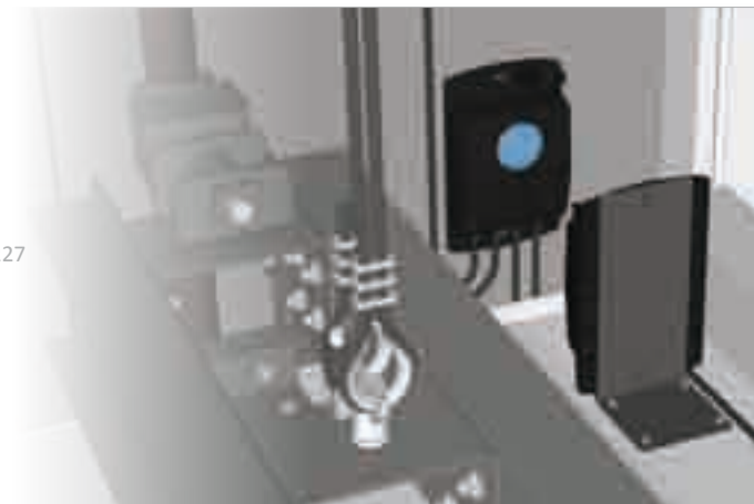
Positionnement du boîtier boîtier NI à 30 cm en face du boîtier IR
