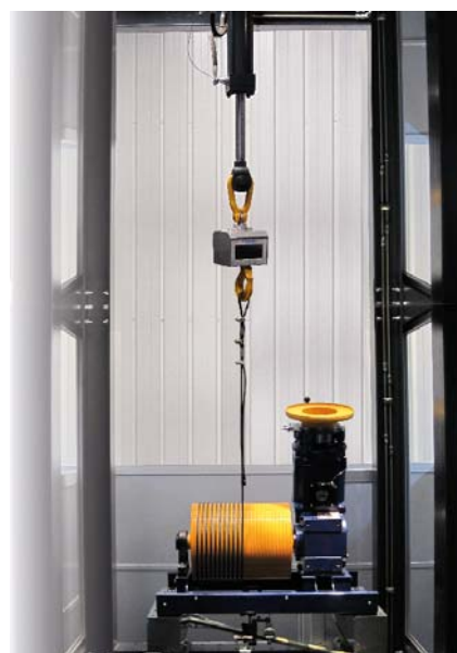
Simulation des charges par vérin
