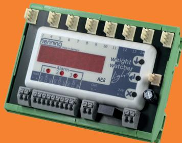
Après le calibrage des capteurs de charge de câble LS-light, l'unité d'évaluation AE8 indique la charge dans la cabine.
